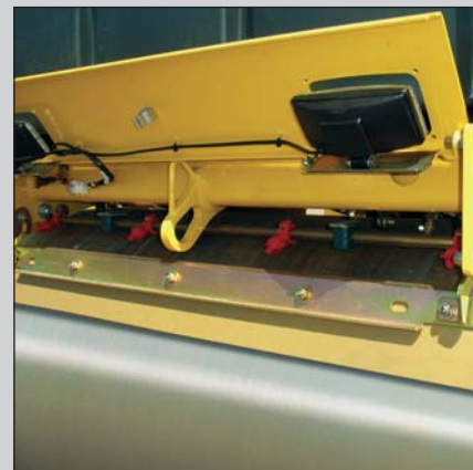
Sistema di spruzzatura dell'acqua a pressione sicuro ed esente da corrosione. Gli ugelli spruzzatori con innesto a baionetta consentono una facile pulizia.
