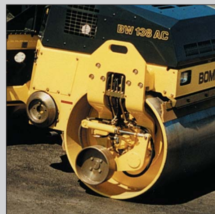
Tagliaasfalto con 3 attrezzi per tagliare e comprimere l'asfalto (opzione), con il rullo conico fino al bordo di delimitazioni laterali.
