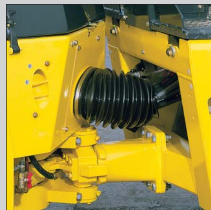
Il giunto oscillante articolato per le sollecitazioni più gravose e un'eccellente manovrabilità.
