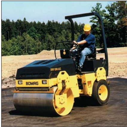
Ampia sicurezza per il manovratore grazie al ROPS, alla cintura di sicurezza e all'interruttore di sicurezza del sedile.
