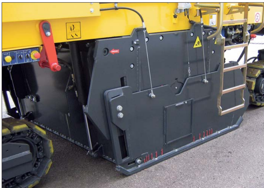
Marcature ben visibili per una partenza precisa. Regolazione della profondità di fresatura tramite sensori a fune in dotazione di serie.
