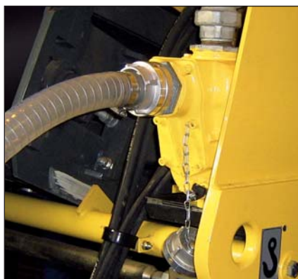
Rifornimento acqua indipendente in cantiere.
