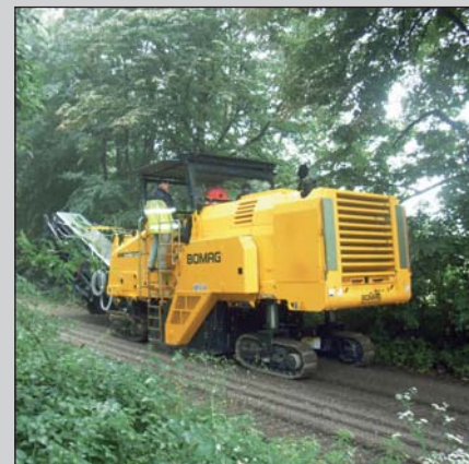
Rapida e manovrabile con nastro retraibile in caso di asportazione e deposito in presenza di ostacoli naturali.
