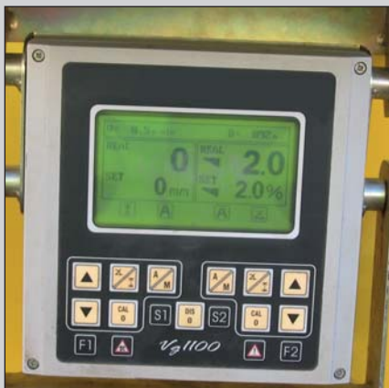
Rapide informazioni relative all'intera macchina, controllo automatico della profondità di fresatura „Intelplaner“.
