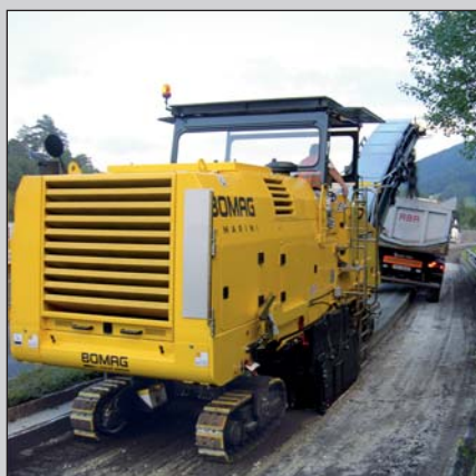
Nessun pericolo di sprofondamento grazie ai cingoli di grandi dimensioni.
