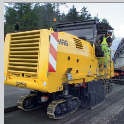
Buona visuale sul cantiere e sull'autorimorchio grazie alla disposizione degli elementi di controllo su entrambi i lati.
