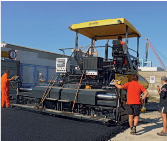
BOMAG SIDEVIEW: l'intera piattaforma operatore, tetto compreso, si può spostare lateralmente fino a uno sbalzo massimo di 50 cm.
